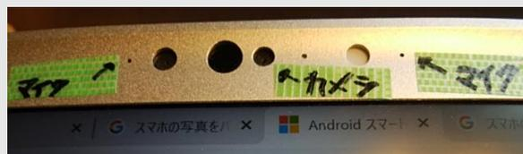
▲カメラと左右のマイク (ディスプレイ上部の枠に内蔵されている)。
