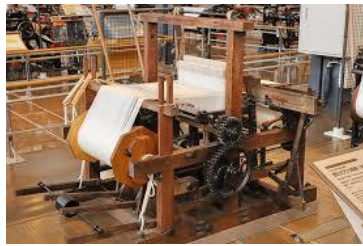
最初の動力織機 (豊田汽力織機)
